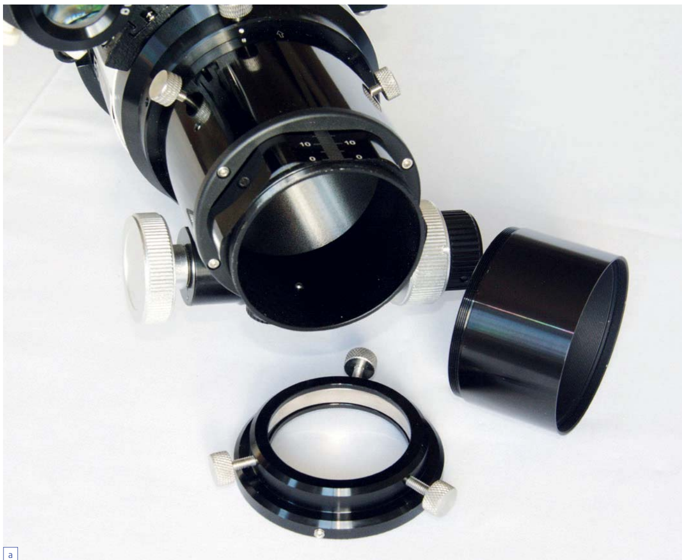
Abb. 3: Details im Blick: Die 2-Zoll-Klemmung (a) und die Sucherhalterung (b).
