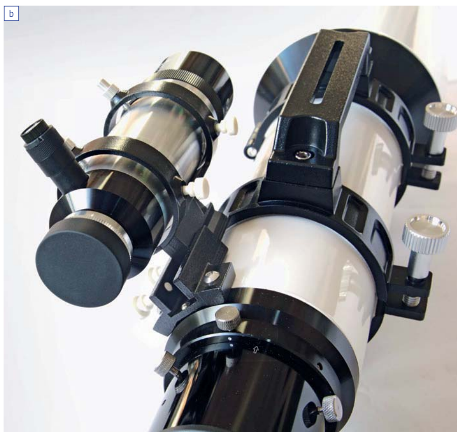
Abb. 3: Details im Blick: Die 2-Zoll-Klemmung (a) und die Sucherhalterung (b).
